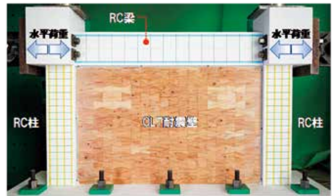
写真2 縮小試験体による構造実験
