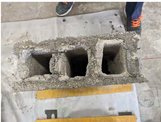
写真 5.4.2.1-6 実験前に破損した試験体
