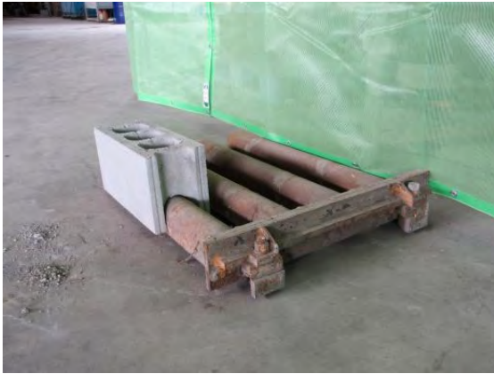
横筋用ブロック製造に必要となる部品 (コアプラー)
