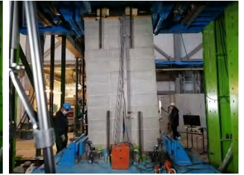
写真 4 試験体 C の加力終了時の亀裂(W面)
