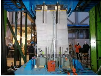
写真 3 試験体 B の加力終了時の亀裂(W面)
