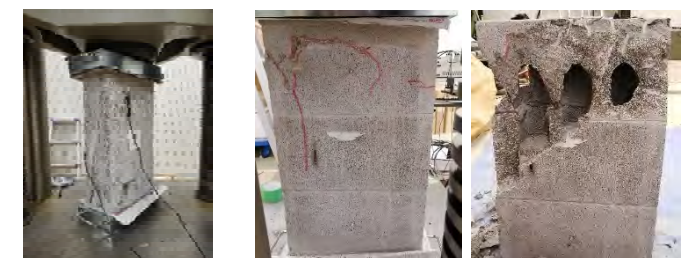
写真5 圧縮加力時 写真6 ひび割れと空隙(試験体a)
