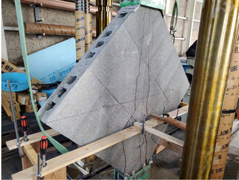
写真 5.6(2)-2 試験体 B の破壊状況(1):表面
