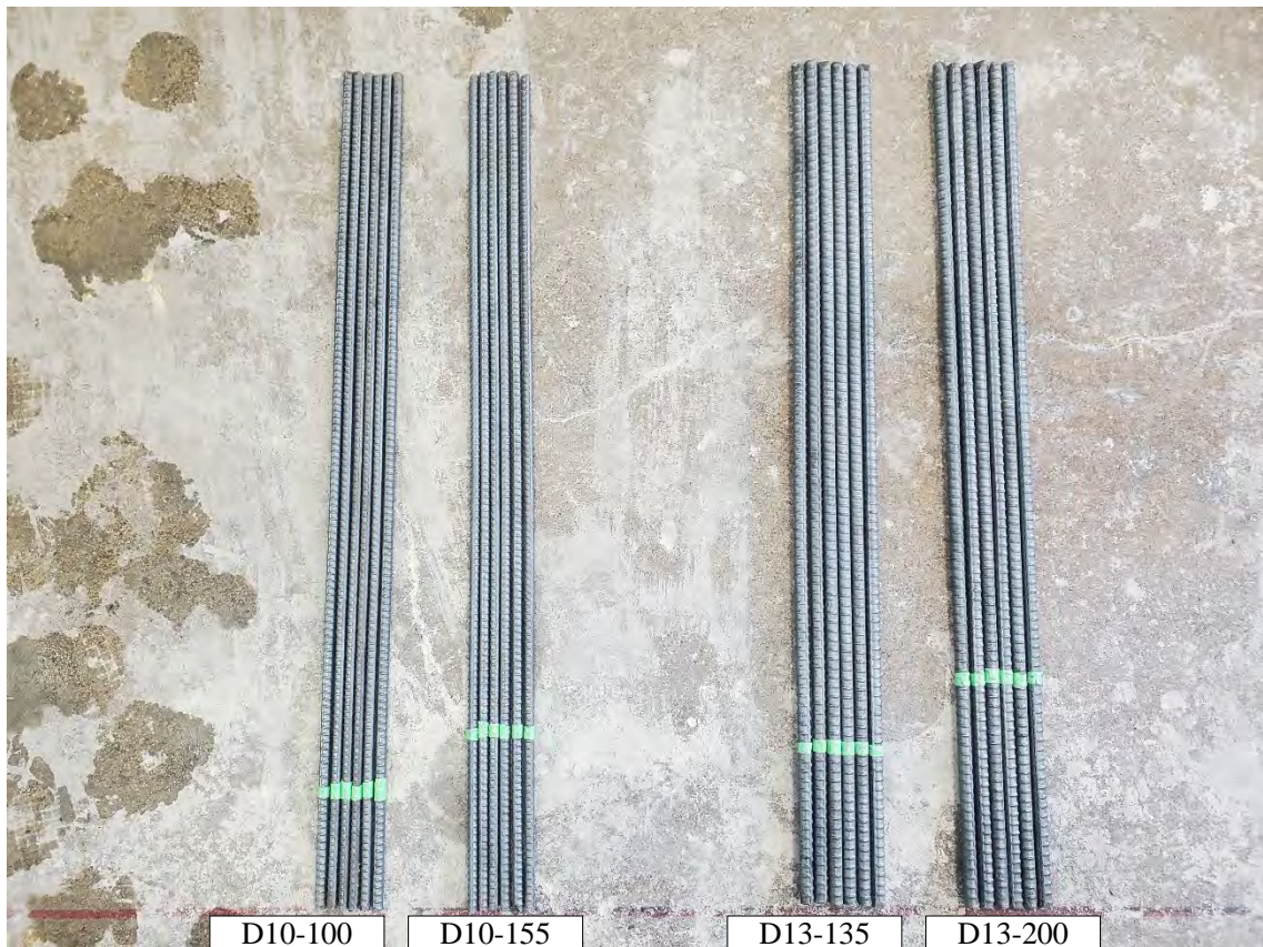
写真 5.7(4)-1 あと施工に使用した鉄筋
