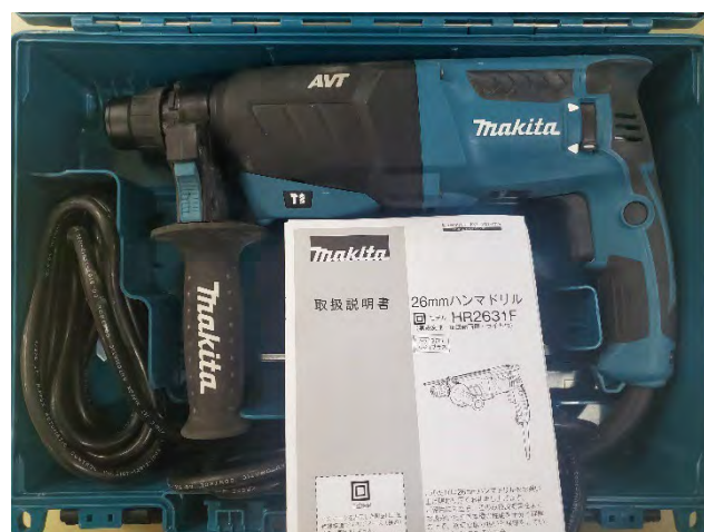
写真 5.7(3)-2 あと施工アンカー用の穿孔に使用した振動ドリル
