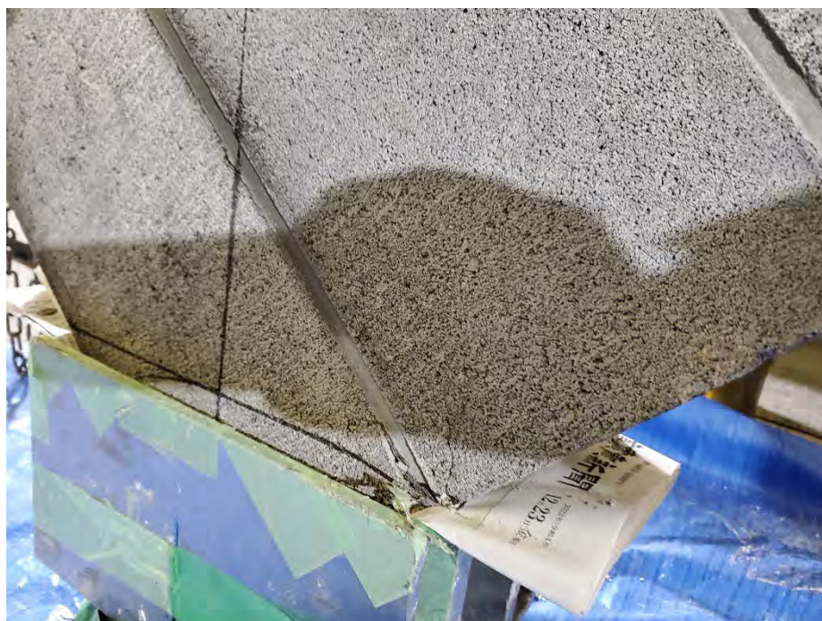
写真 5.6(2)-1 試験体 A の破壊状況(4):裏面の下端加圧部
