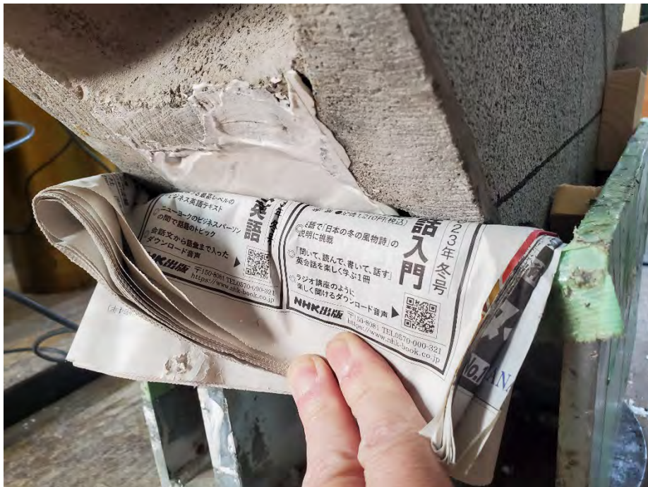
写真 5.6(2)-2 試験体 B の下端加圧部の空洞部への石膏の充填状況
