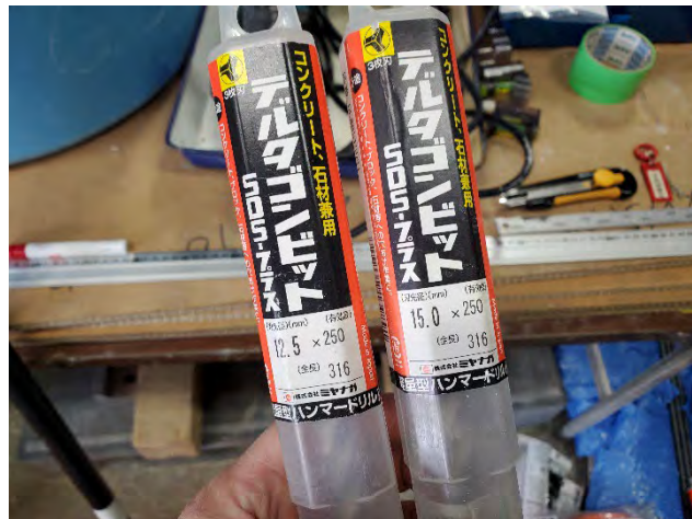
写真 5.7(3)-1 あと施工アンカー用の穿孔に使用したビット
