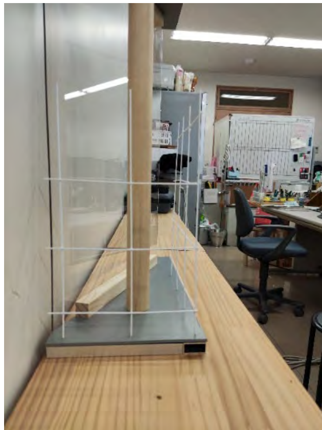
写真 5.8(2)-10 先組み鉄筋模型
