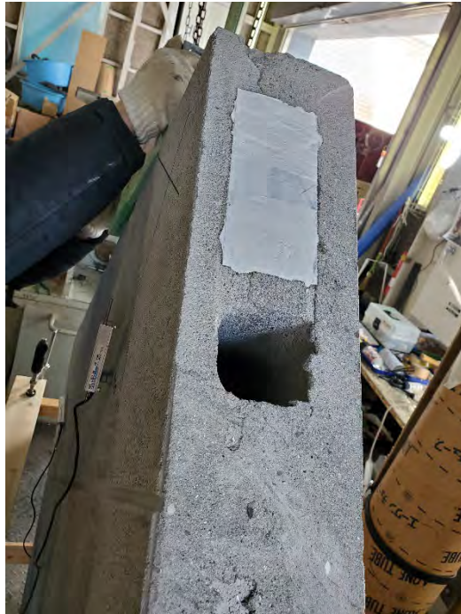
写真 5.6(2)-2 試験体 B の上端加圧部の空洞部への石膏の充填状況
