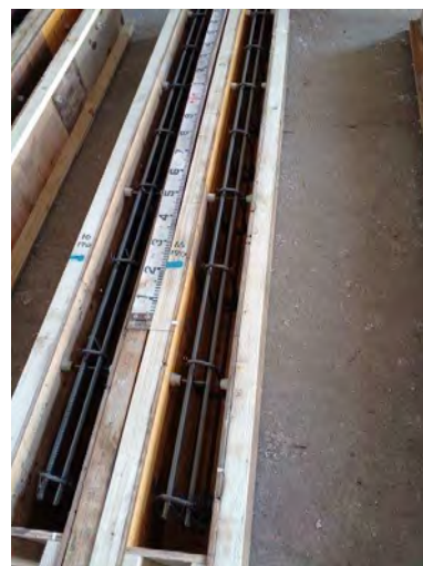
(f) 試験体 B : アンカーのピッチ
