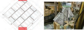
図 05-6 ダイアゴナル圧縮試験：段積み試験体
