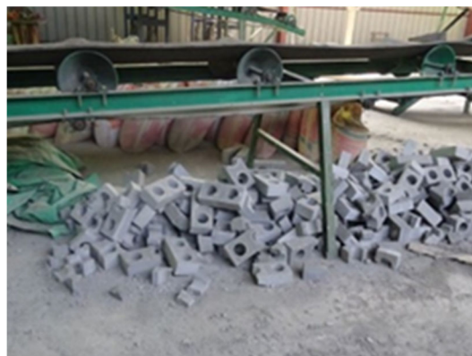
写真 8-1-4 JICA 供与のプラントによる無焼成煉瓦の製品
