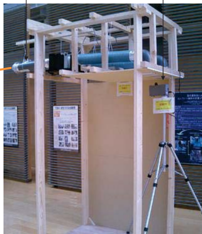
排気風量測定の実験体
