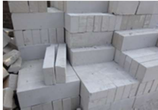
写真 7-12 建設資材店で販売されている軽量気泡コンクリートブロック
