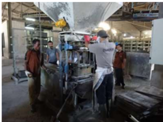
写真 7-7 Cisangkan でのコンクリートブロック製造状況
