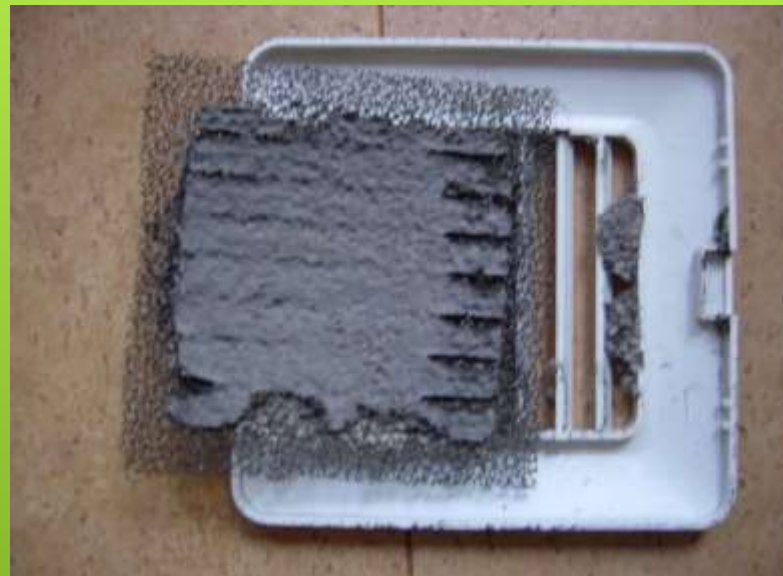
室内排気口フィルターの閉塞
