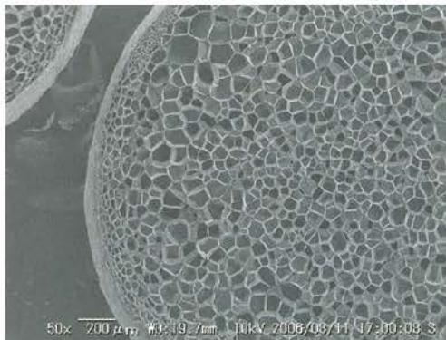
図3 発泡プラスチックの断面写真
