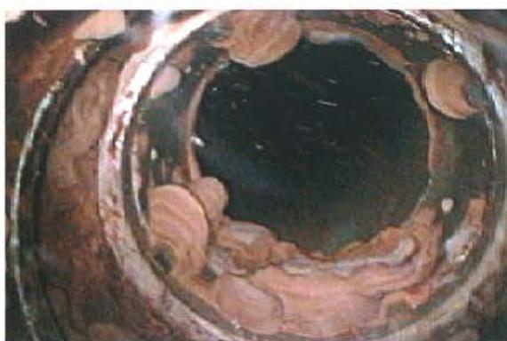
写真1 水道用塩ビライニング钢管内
