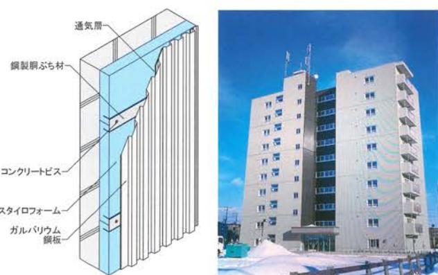
図1 工法の概要図
