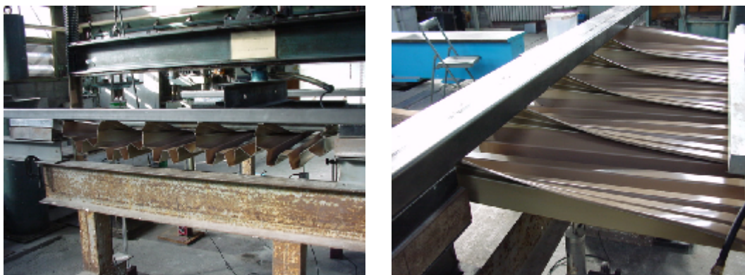
解説写真 2.1 大変形が生じても脱落しない鋼板外装材の一例（負圧想定加圧時） 2
